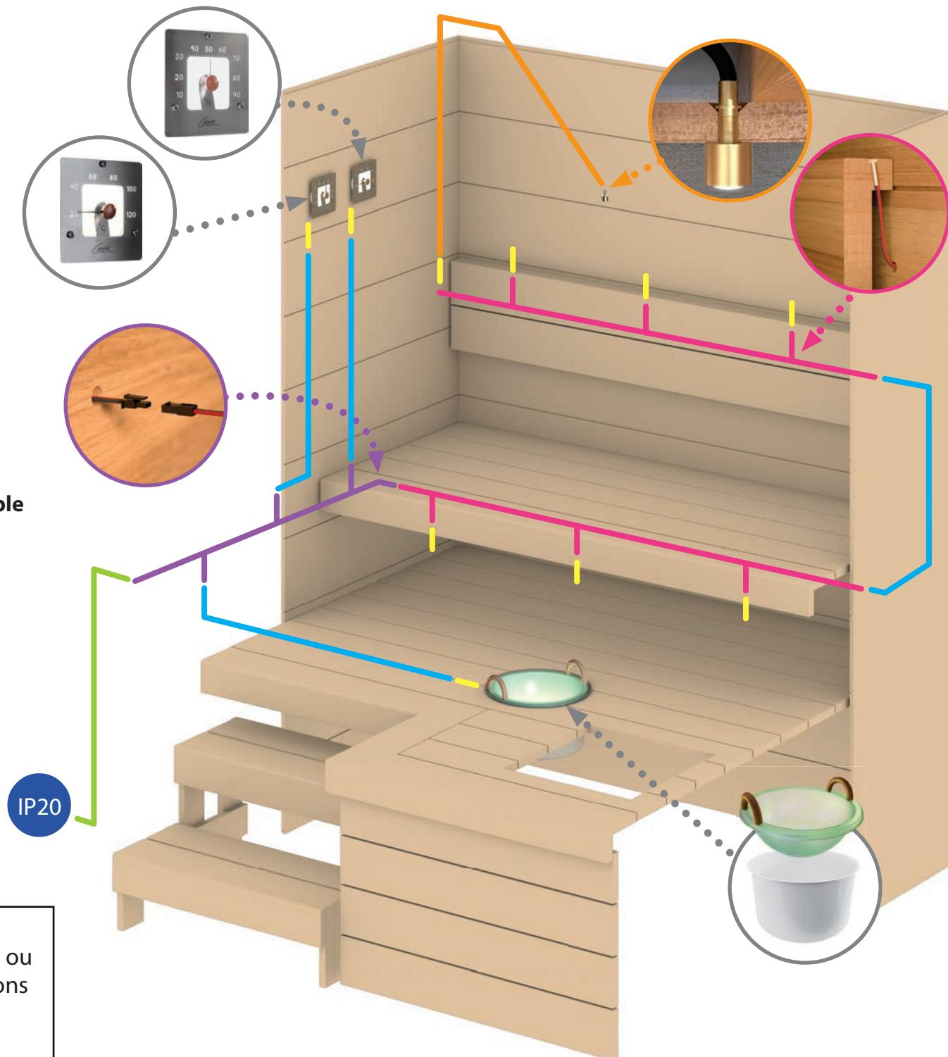
Si la température du sauna est supérieure à +90°C ou que l'on utilise un poêle à bois, nous recommandons d'utiliser la série de fibre optique Cariitti.
